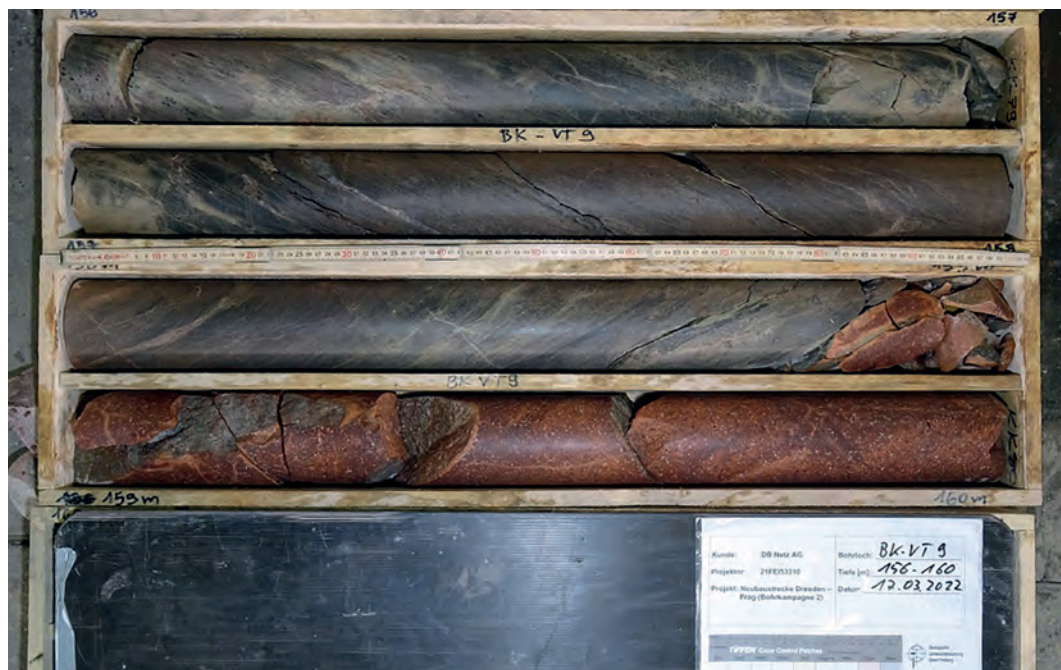
Bohrkerne aus der zweiten Bohrkampagne, die insgesamt 15 Kernbohrungen mit Bohrtiefen bis zu 500 m umfasst
