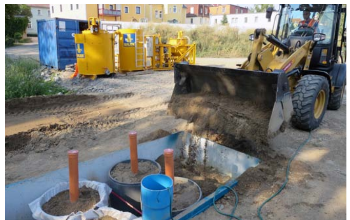
▲ Simulation der Baugrund- und Grundwasserverhältnisse in Versuchszylindern für die Manschettenrohrinjektion
