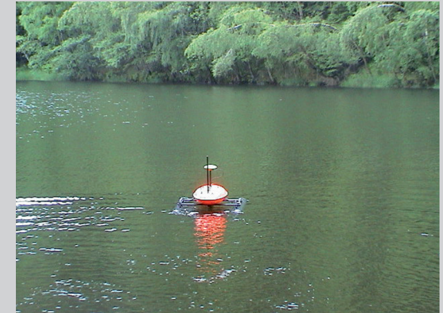
INN-Messung mit Sonobot auf einer Talsperre
